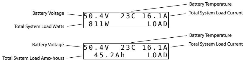
Figure 4-12. Écrans d'exploitation du système en mode décharge.
