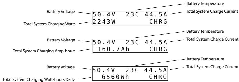
Figure 4-11. Écrans d'exploitation du système en mode charge
