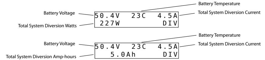
Figure 4-13. Écrans d'exploitation du système en mode dérivation.
