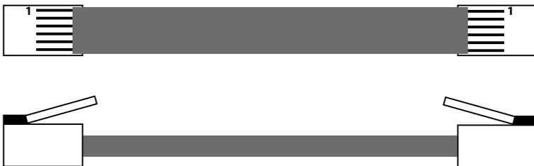
Figure 5-1. Assemblage du câble du compteur
